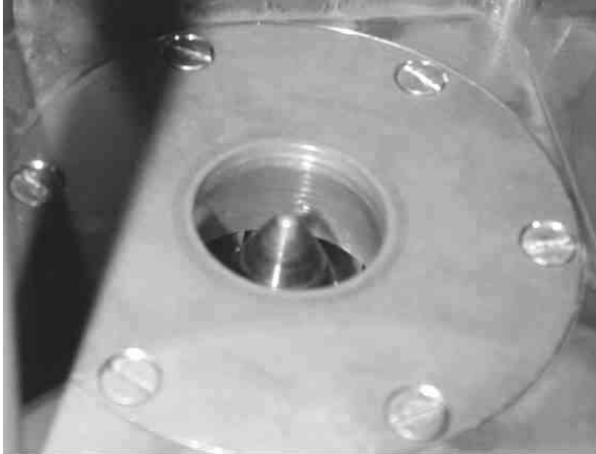
FIG. 3.5: Cône central du swirler (en place, vu de la chambre)
